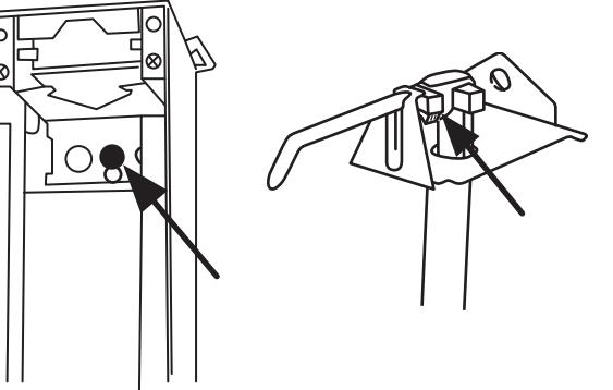
Jedes Grundmodell trägt eine Farbcodierung auf der Konsole. Die Pumpen sind durch ein farbiges Dosierrad gekennzeichnet (außer Schaumpumpen, siehe unten). Die Farbcodierung von Grundmodell und Dosierrad müssen übereinstimmen.
